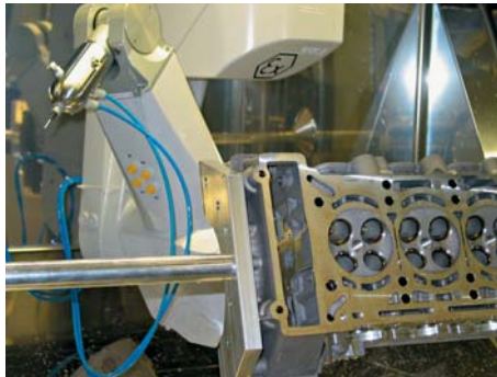
Bild 1 Automobilbauteil bei der roboter- gestützten Sauberkeitsanalyse.
