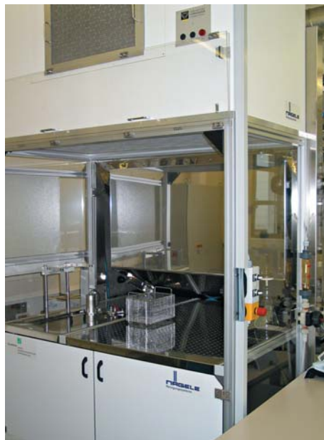
Bild 3 Ultraschall-Analysebereich im Sauberkeitslabor.
